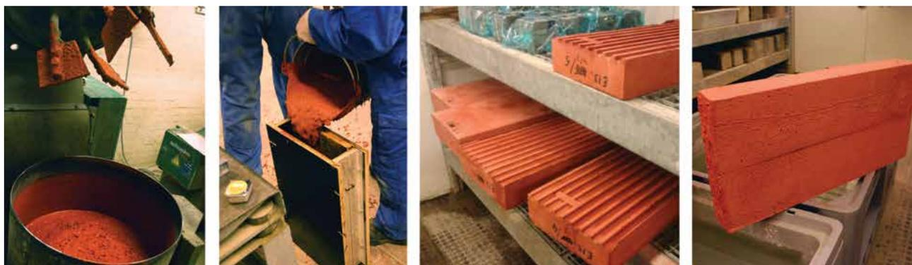
Essais au laboratoire portant sur la teinte, la surface et la texture du béton
